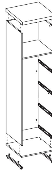
**2.2** Posicione o tampo e a base e fixe utilizando uma chave philips
