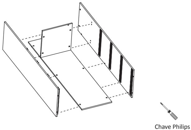
**2.1** Posicione as laterais pré montadas com o fundo, prateleira e montante. Fixe utilizando uma chave philips.
