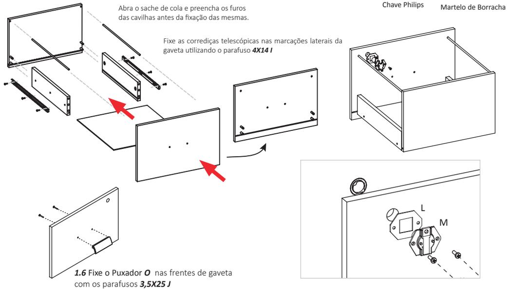
**1.4** Insira os pinos minifix **C** e cavilhas **E** no fundo e na frente. Encaixe as laterais e trave os tambores. Encaixe o fundo 3mm no canal das laterais, posicione a frente e trave os tambores **A**. Por fim, fixe as corredeiras com os parafusos **4x14 I**
