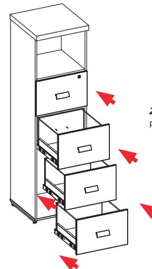
**2.3** Com a corredeira telescópica recuada encaixe a gaveta até o final e repita o processo nas demais gavetas separadamente para finalizar a montagem.
